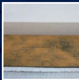
RENO Basic Akoestisch. Akoestische isolatie en dekvloer in slechts 38mm.
